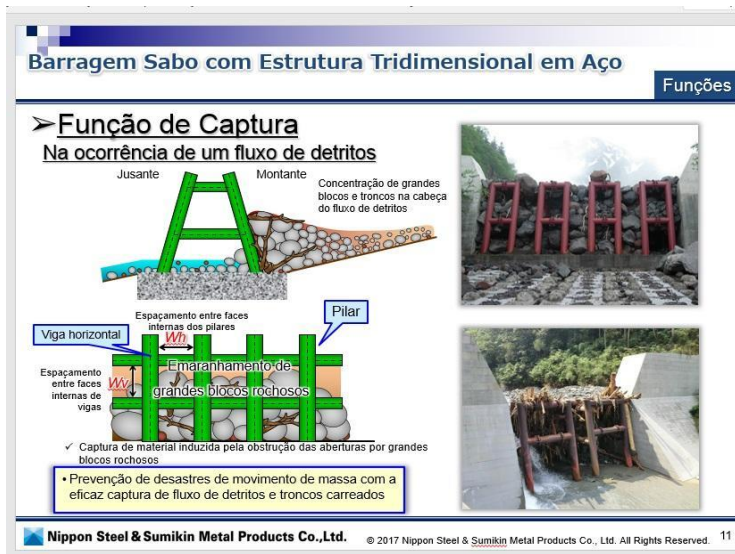
鋼製スリットダムの作動原理
